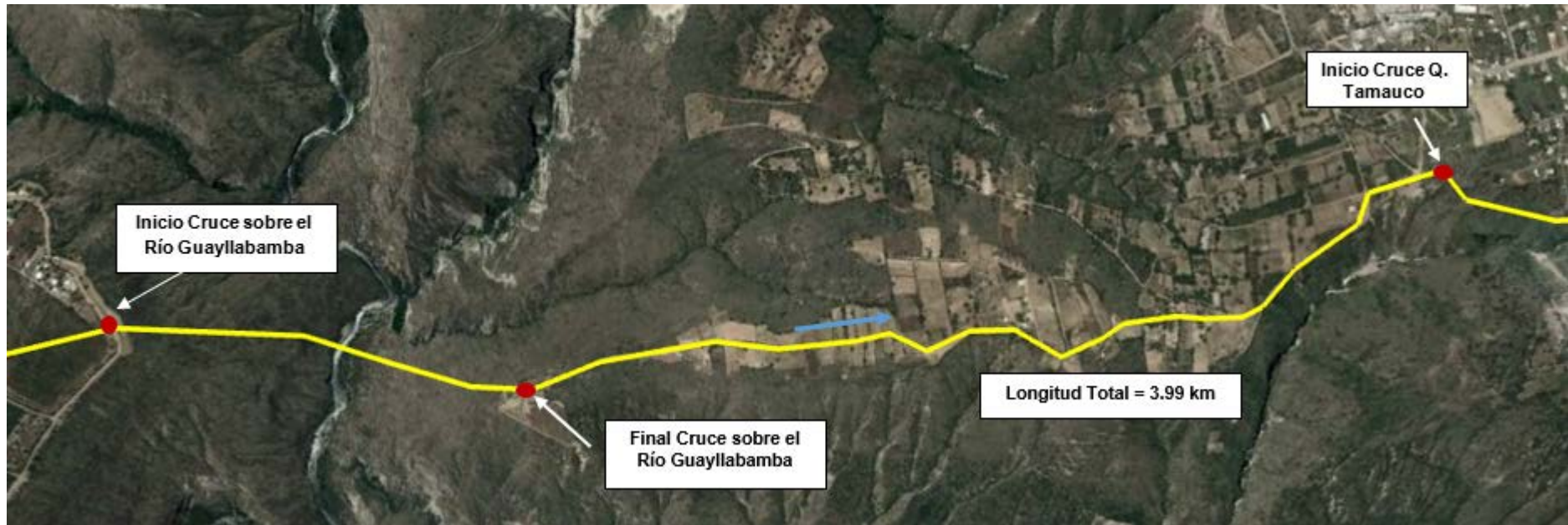
Figura 4 Implantación del Tramo 2 de la línea de conducción LC Puenbo Calderón, sobre la fotografía Google.
