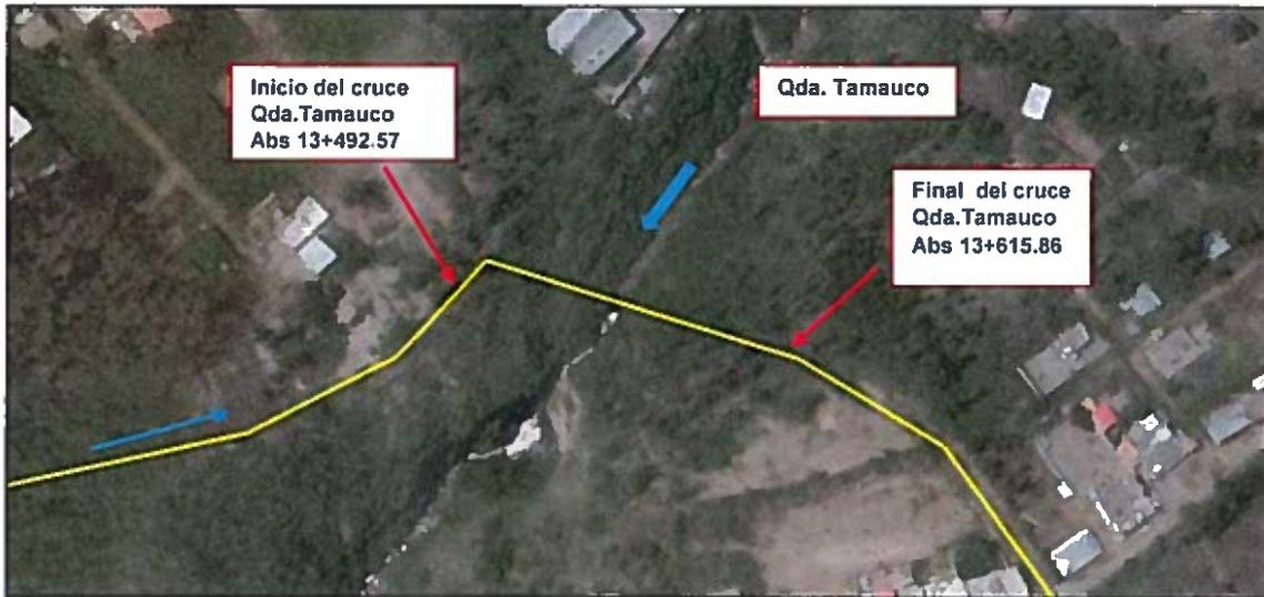
**Figura 36. Cruce de la línea de conducción sobre la quebrada Tamauco en la fotografía Google**
