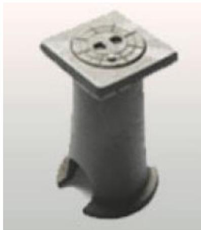
En la Caja de Vereda, el elemento que sirve de sujeción a la tapa con el cuerpo debe ser una cadena o un perno, de acero de bajo carbono SAE 1010 de acuerdo a la norma ASTM A307 Grado A, con recubrimiento de protección anti-corrosiva de zinc por inmersión en caliente bajo la norma NTE INEN 672, con un diámetro de 6 mm y una longitud mínima de 100 mm o abisagrada.
