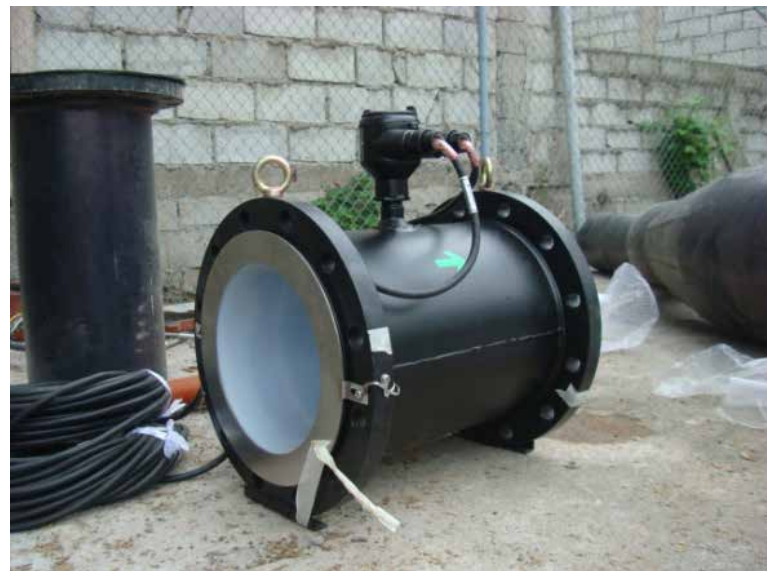
Macromedidor para el tanque IEOS-Pusuquí
