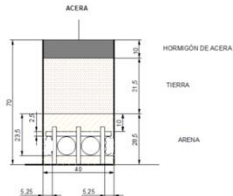
Figura 8 Esquema de la Zanja para Instalación de Ductos Para la Fibra Óptica
