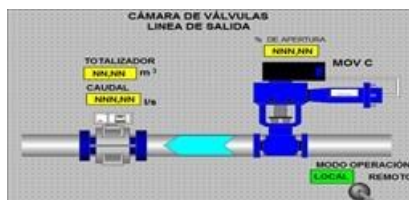
Representación válvulas de la línea de salida
